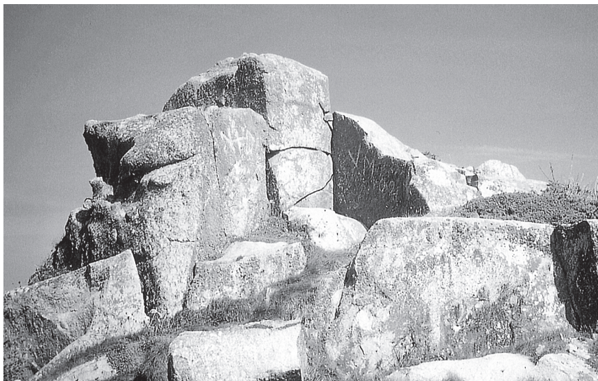
Photo 7 – Petite carrière de granodiorite à Bréhat au lieu-dit « La Chaise de Renan ». L'extraction était guidée par les diaclases subverticales (cl. L. Chauris, 2 octobre 2002)
