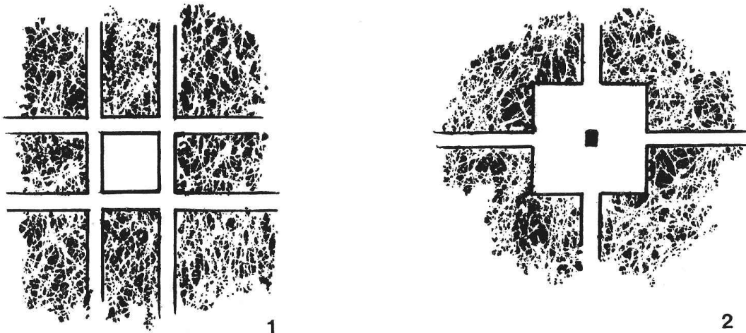
Principes de trames : la solution de la case vide (1) — déjà expérimentée lors de la reconstruction de Rennes, en 1720 — détermine des plateaux libres qu'environne une circulation périphérique. Un plan central rigoureux détermine au contraire une place-carrefour (2), où des voies axiales viennent se recouper sur l'axe-pivot.
